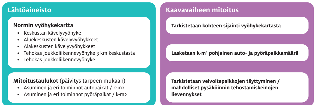
Kuva 7. Pysäköintipaikkojen lukumäärän mitoituksen vaiheet
